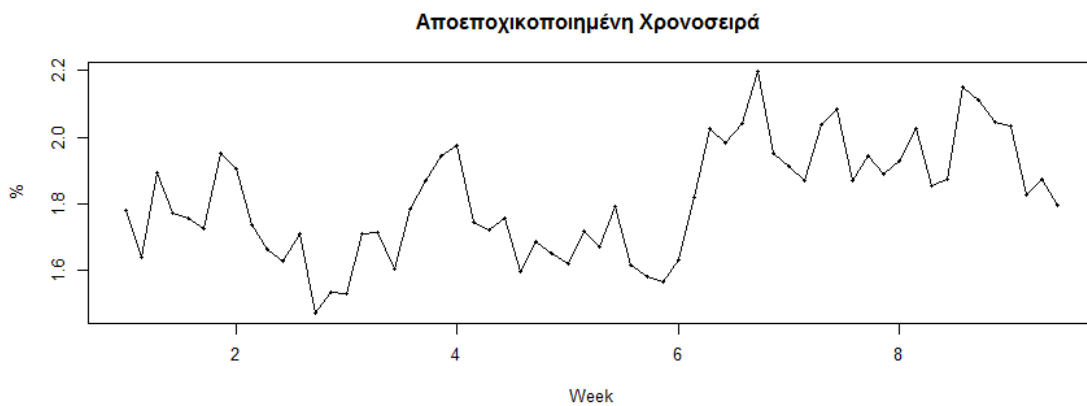
Εικόνα 7.3.1.2.2: Η αποεποχικοποιημένη χρονοσειρά με την επί τις εκατό κατανάλωση της χρήση των συνδεδεμένων σε UPS συσκευών στο υποκατάστημα Αττικής
